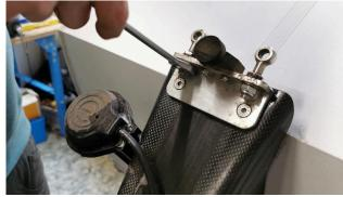
2. Die Augenschrauben vom Aluwinkel abschrauben und aufbewahren. Zum Lösen der M8 Muttern Die Augenschrauben festhalten (zum Beispiel einen Schraubendreher durch das Auge stecken).
