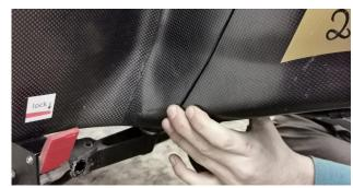
13. Nun prüfen und sicherstellen dass Vorder- und Hinterteil im unteren Bereich der Teilung so wenig seitlichen Versatz wie möglich aufweisen. Durch Rütteln und Drücken kann die Position der Teile zueinander verändert werden so lange die Augenschrauben noch nicht festgezogen sind.
