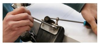
10. Die Augenschrauben wieder in den Winkel einstecken. Die mitgelieferten neuen selbstsichernden M8 Muttern jeweils mit etwas Schraubensicherung versehen und wenige Umdrehungen auf das Gewinde der Augenschrauben drehen. Die Augenschrauben sollen sich noch leicht bewegen und locker sitzen, denn die genaue Position kann nur zusammen mit dem Vorderteil der Libelle eingestellt werden.
