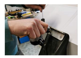
4. Die Senkkopfschrauben M6x25 lösen und entfernen. !Dabei auf guten Sitz des Werkzeugs achten. Die Schrauben lassen sich schwer Lösen und ein Ausleiern der Sechskant oder Torx Aufnahme der Schrauben führt zu Komplikationen.
