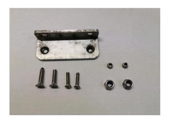
17. Nach Abschluss des Winkeltausches sollten übrig bleiben: der alte Winkel 2x M8 und 2xM5 alte selbstsichernde Muttern. 2x M6x25 alte Senkkopfschrauben 2x M5 Schrauben von der Plastikhalterung des Gummipuffers
