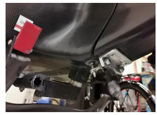
12. Die Stirnflächen der Teilung sollten unten jetzt einen schmalen Spalt (2mm genügen) aufweisen. Ist dies nicht der Fall, so müssen die selbstsichernden M8 Muttern etwas gelöst werden.
