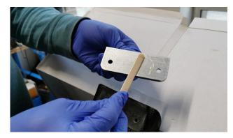
**6. Einmalhandschuhe und Schutzbrille verwenden!** Epoxidharz und Härter im Pappbecher mit dem Holzspatel sorgfältig mischen. Die Auflagefläche an der Libelle mit einer dünnen Schicht Harz benetzen.
