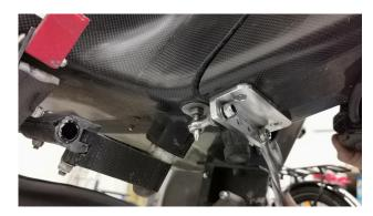
14. Nun werden die M8 Muttern vorsichtig so weit festgezogen bis der Spalt der Teilung auf der jeweiligen Seite so Gering wie möglich ist. Achtung: Die M8 Schrauben nur soweit festdrehen dass keine Unnötige Zugkraft aufgebaut wird. Wenn die passende Position ermittelt ist, werden die Augenschrauben durch Kontern der schmalen M8 Muttern befestigt.
