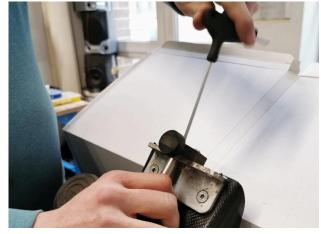
9. Den Gummipuffer inklusive schwarzer Kunststoffhalterung wieder befestigen. Dazu je einen Tropfen Schraubensicherung in die M6 Gewindelöcher des Winkels geben und dann das Teil mit den mitgelieferten M5x16 Linsenkopfschrauben befestigen.
