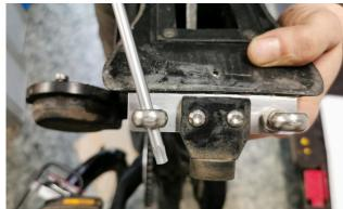
15. Das Vorderteil wieder vom Hinterteil entfernen und die Augen durch vorsichtiges Drehen gerade und parallel ausrichten. Dabei darauf achten dass sich die gekonterten Muttern nicht lösen und die Augenschrauben weiterhin fest sitzen.
