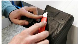
Den Winkel vom Rahmen abnehmen und die Auflagefläche an der Libelle überüfen. sie sollte sauber und Fettfrei sein. Der Grat um die Gewindelöcher sollte mit einem Kegelsenker oder einem Cuttermesser vorsichtig entfernt werden.
