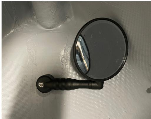
2. Schrauben M5x25 von innen und mit 15mm Unterlegscheibe und Hutmutter mit Schraubensicherung von außen anschrauben
