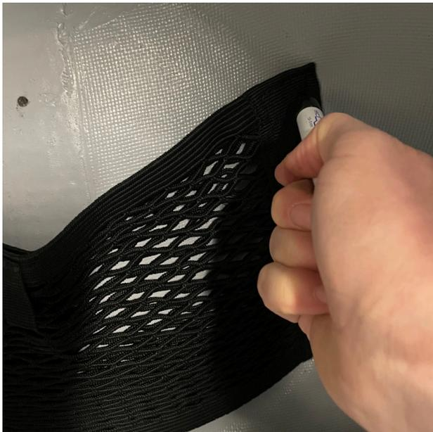
4. Packnetz nach oben leicht auf Spannung halten und dann die Löcher anzeichnen
